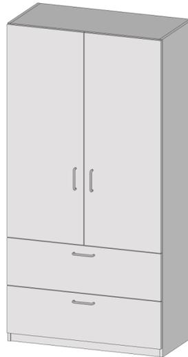
Der Schrank soll mit den Abmessungen 2000 x 1000 x 500 (HxBxT) mm angelegt werden. Im unteren Bereich besitzt der Schrank 2 Schubladen, die Lochreihen beginne bei einer Höhe von 650 mm. Ein Sockel wird ebenfalls eingebaut.
